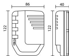
Сигнализаторы серии SCACCO – приборы со встроенным каталитическим сенсором, предназначенные для обнаружения повышенных концентраций метана и сжиженного нефтяного газа (L.P.G.).
