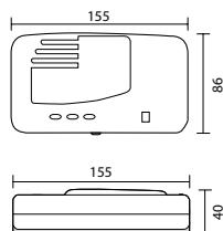
Сигнализаторы серии DOMINO – приборы со сменным катализитическим сенсором, предназначенные для обнаружения повышенных концентраций горючих газов. Модельный ряд представлен двумя приборами – для обнаружения метана (CH<sub>4</sub>), сжиженного нефтяного газа (L.P.G.).
