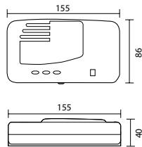
Сигнализаторы серии DOMINO – приборы со сменным электрохимическим сенсором, предназначенные для обнаружения повышенных концентраций угарного газа. Модельный ряд представлен одним прибором – для обнаружения угарного газа (CO).
