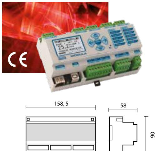
MODULA блок управления предназначен для обнаружения горючих и токсичных газов. Легкая установка, интуитивная настройка и гибкая расширяемость позволяет удовлетворить потребность потребителей в системе газовой безопасности. Модульная конструкция позволяет легко установить блок на стандартную DIN рейку.
